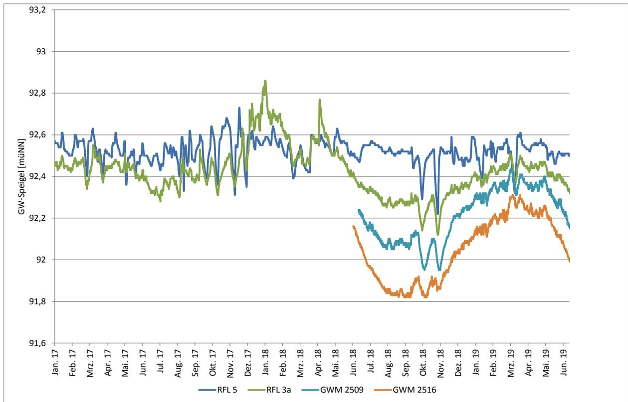
Abb. 4 Grundwasserstandsentwicklung in ehemaligen Hessenwasser-Messstellen 2509 und 2516
