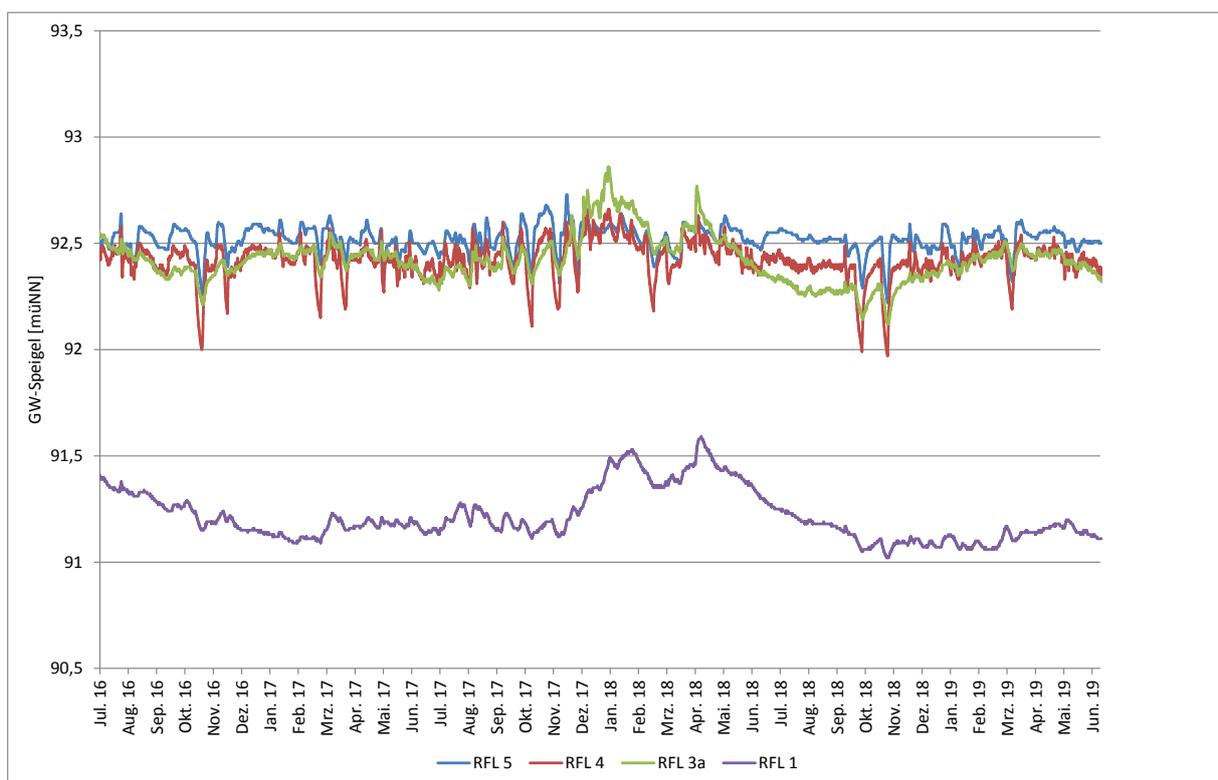
Abb. 2 Grundwasserstandsentwicklung in den Rammfilterlanzen seit Sommer 2016
