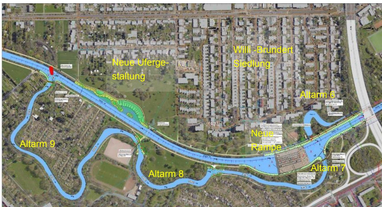
Das bestehende Klappenwehr soll durch eine Rampe ersetzt werden, die um ca. 350 Meter flussaufwärts angeordnet wird. Die Altarme 7, 8 und 9 sollen untereinander verbunden und an das Nidda-Mutterbett angeschlossen werden. Dadurch soll der Altarmzug besser durchströmt werden. Um dieses Ziel zu erreichen, ist es notwendig, etwas unterhalb des Einlaufs in den Altarm 9 eine Buhne in den Fluss zu schütten. Sie wird einen Teil des Niddawassers
